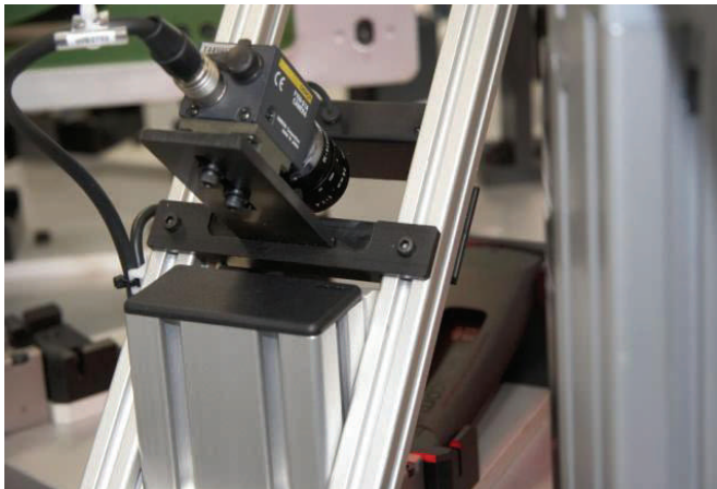
Kamera for kontrol af lysfunktion
